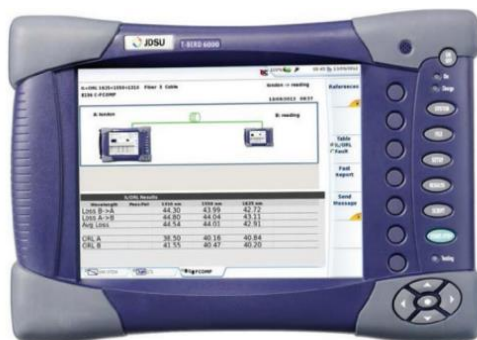
Figura 13 Aspecto de un OTDR de campo
