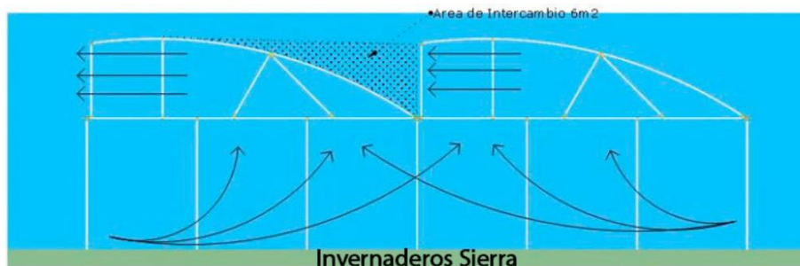
Figura 6. Esquema y Circulación de Aire de un Invernadero tipo Sierra
