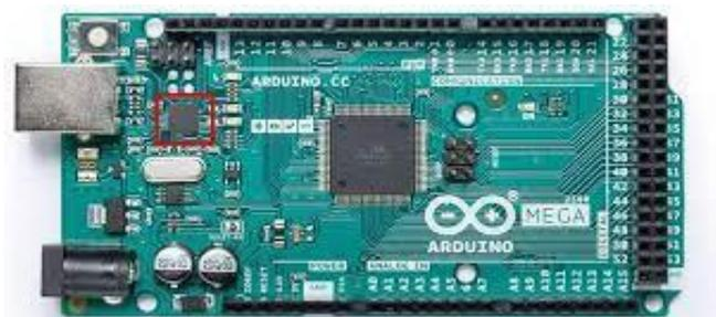
*Nota:* Imagen de Arduino Mega con sus puertos, componentes y pines (Arduino, 2017).
