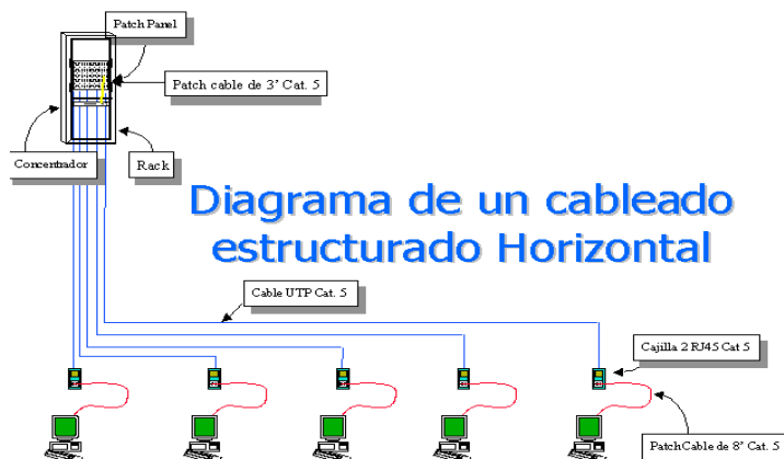
Figura 2. Diagrama de cableado estructural.
