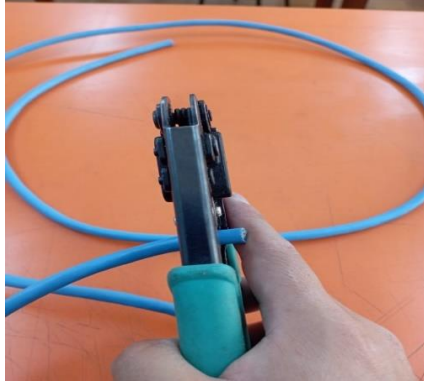
Figura 41. Corte del capuchón del cable UTP.
