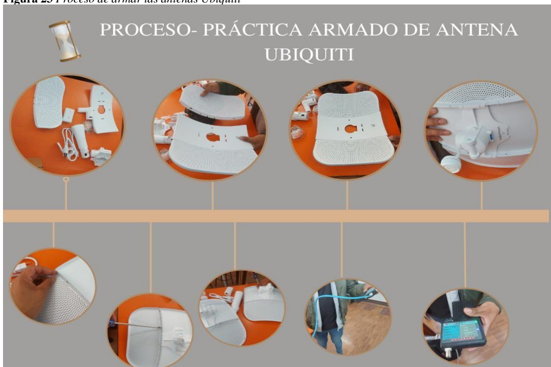
Figura 23 Proceso de armar las antenas Ubiquiti
