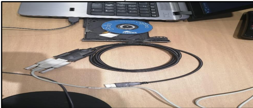
Figura 31. Cable de consola e Instalación del software.
