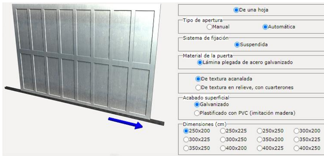
Figura 19 Puerta abatible corrediza para garaje, de acero galvanizado corrediza suspendida, 250x200 cm
