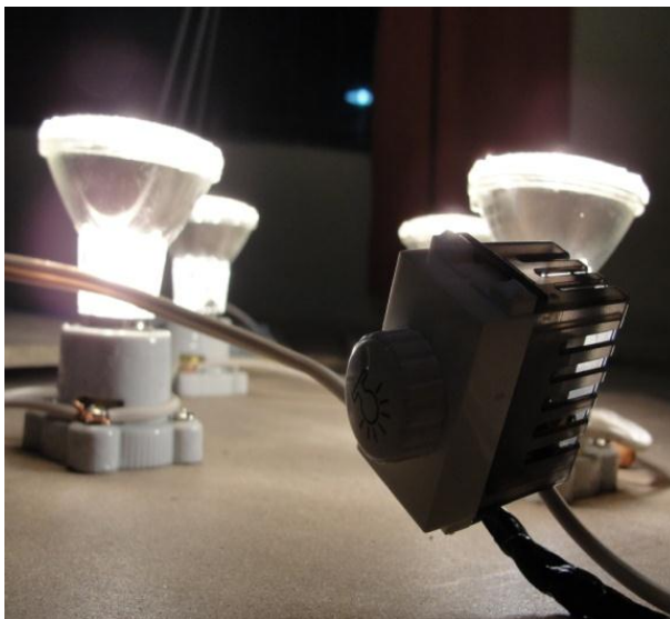
Gráficos no.20-21-22. Colocación de focos calefactores y regulador de intensidad.
