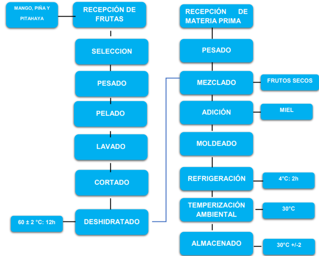
Figura 1.3 Diagrama de flujo de la deshidratación adiabática en la elaboración de barras de frutas deshidratadas
